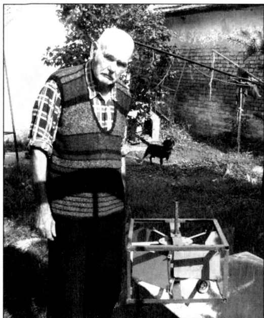
A verbászi Heinrich István szabadalmazott vízszintes szélkereke
