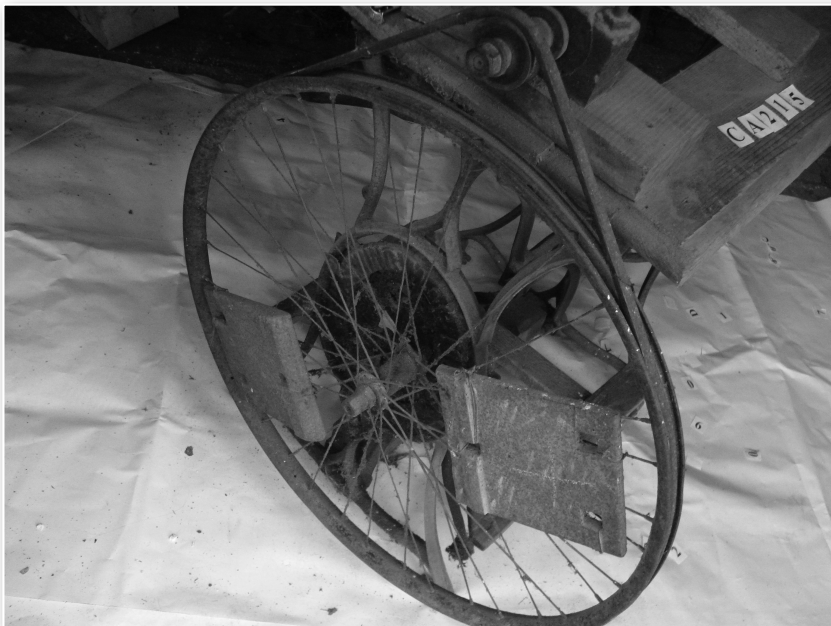
Lábítós varrógépből átalakított, lábbal hajtható köszörű (Pacsér)
